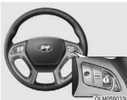
3. Pritisnite prekidač (1) -/SET i pustite ga nakon što ste dostigli željenu brzinu. SET indikaciono svetlo na instrument tabli će zasvetleti. Otpustite papučicu gasa u isto vreme. Željena brzina će se automatski odžavati.
