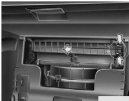
3. Izvadite kućište filtera uređaja za klimatizaciju pritiskom na rezu sa desne strane poklopca.
