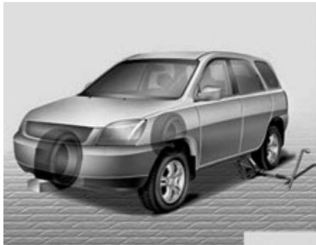
4. Izvadite ključ za odvrtanje i zavrtanje, dizalicu, ručku dizalice i rezervni točak iz vozila.
