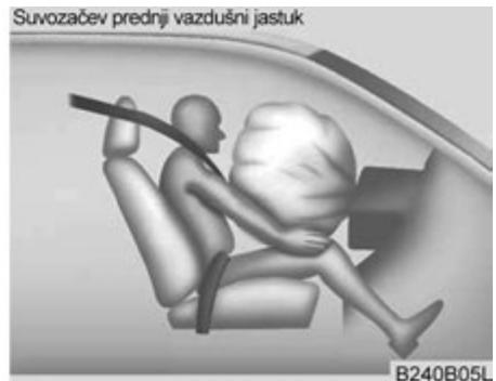
Nakon aktiviranja, šavovi na zaštitnoj oblozi kola upravljača će se razdvojiti pod pritiskom usled ekspanzije vazdušnog jastuka dalje otvarajući poklopac što će omogućiti potpuno naduvavanje vazdušnog jastuka.
