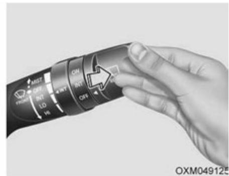
Odgurnite ručicu od sebe da bi tečnost za pranje stakala isprskala zadnji prozor i da bi se uključili zadnji brisači u ciklusu 1~3. Prskanje tečnosti i rad brisača će se nastaviti dok ne otpustite ručicu (ako je ugrađena).
