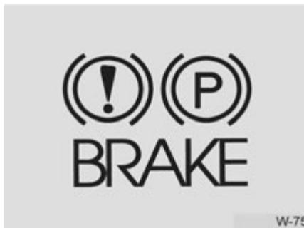
Proverite svetlo upozorenja za kočnice okretanjem kontakt ključa u položaj ON (nemojte startovati motor). Svetlo ručne kočnice biće uključeno ako je ručna kočnica podignuta dok je kontakt ključ u položaju START ili ON.
