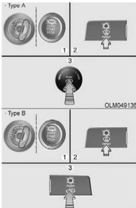
3. Pritisnite dugme za dovod vazduha najmanje 5 puta u roku od 3 sekunde. Svetlo indikatora za dovod vazduha će zatreperiti 3 puta u intervalu od pola sekunde. Ovo označava da je funkcija logike odmagljivanja isključena ili da je funkcija vraćena na programirano stanje.
