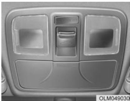
Ukoliko ga vaše vozilo poseduje, krov može da se pomera klizanjem ili da se nagnе (izdigne) pomoću kontrolnog dugmeta koje se nalazi na krovnom panelu.
