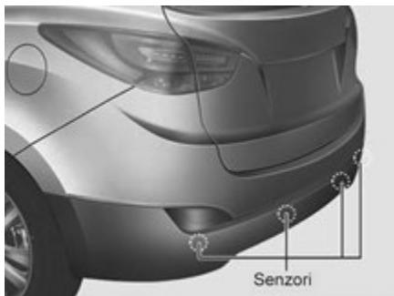
Sistem za pomoć prilikom vožnje u nazad oglašava se zvučnim signalom ako senzori detektuju bilo kakvu prepreku na udaljenosti od 120 cm od vozila. To je samo pomoći sistem i ne zamenjuje pažnju vozača. Domet senzora kao i predmeti koje mogu senzori da detektuju su ograničeni. Kad god vozite u nazad obratite pažnju na sve što se nalazi iza vozila, kao što biste uradili da vozite vozilo bez ovog sistema.
