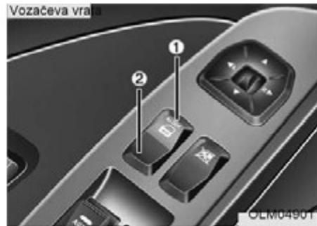
**Centralni prekidač za zaključavanje vrata**
